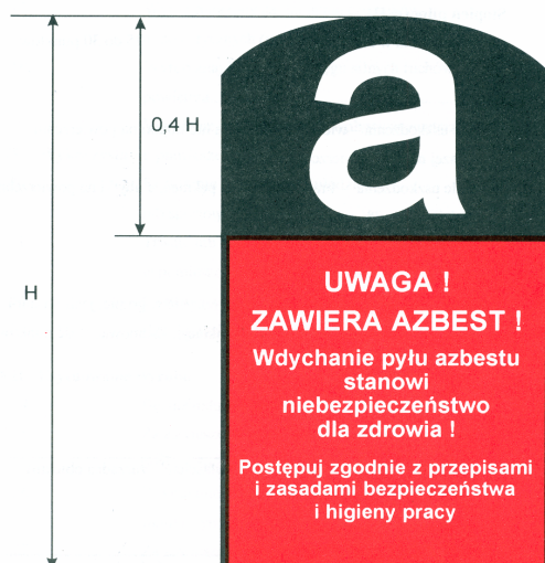
Oznakowanie wyrobów i odpadów zawierających azbest
